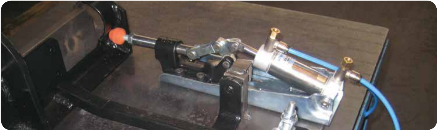
Doppelwirkend, magnetisch und mit Stoßdämpfung Pneumatic cylinders are double acting, magnetic and cushioning
